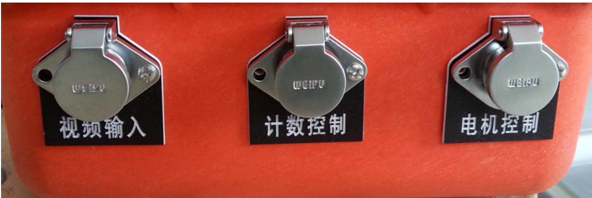
图 5 主控箱体右侧接口
