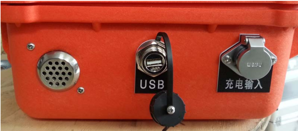
图 4 主控箱体左侧接口
